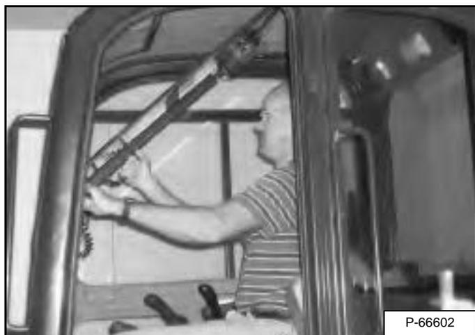
Utilizzare entrambe le maniglie poste sul parabrezza per tirare la parte superiore del parabrezza verso l'interno [Figura OI-20].
