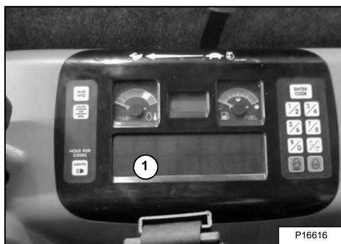
La spia di preriscaldamento (1) [Figura OI-57] si illumina. Le candele di preriscaldamento vengono attivate automaticamente. Quando la spia si spegne, girare la chiave per avviare il motore.
