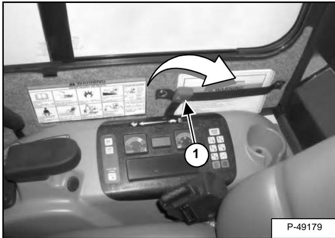
Portare il comando del regime motore in posizione di minimo (1) [Figura OI-53].
