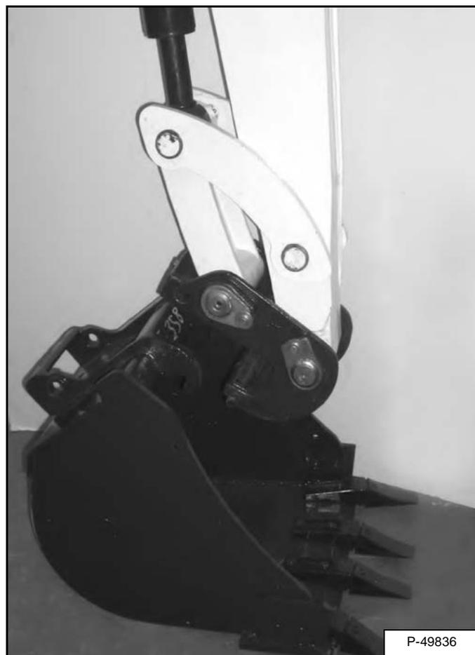
Avviare il motore e avvicinare il bilanciere alla benna [Figura OI-76].
