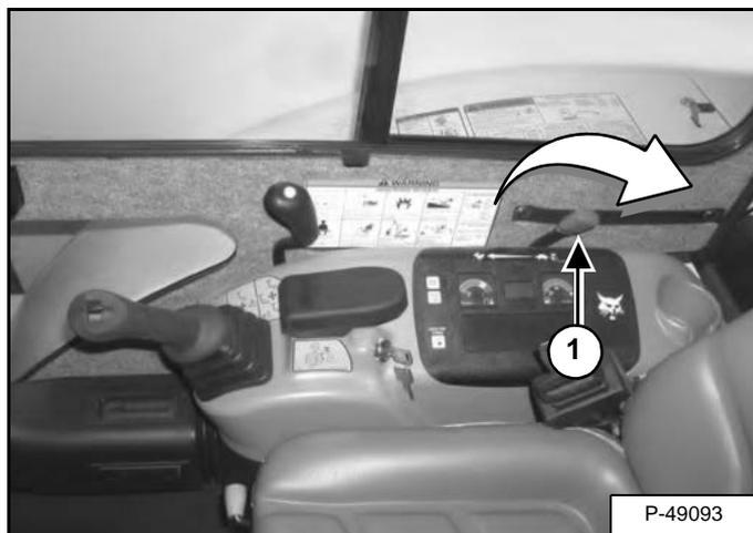
Portare il comando del regime motore in posizione di minimo (1) [Figura OI-51].
