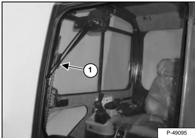
Il parabrezza anteriore è dotato di un tergicristalli (1) [Figura OI-17] e lavavetri.
