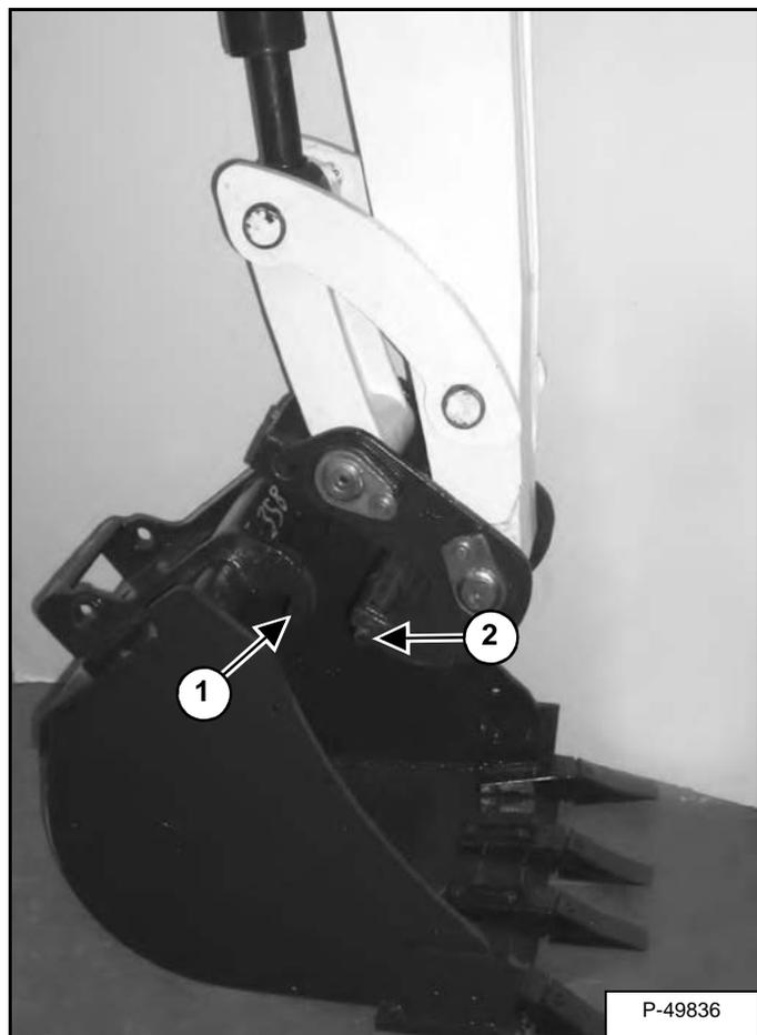
Retrarre completamente il cilindro della benna e abbassare il braccio e il bilanciere finché la benna è al suolo e i perni dell'X-Change (1) si disinnestano dai ganci (2) [Figura OI-85].
