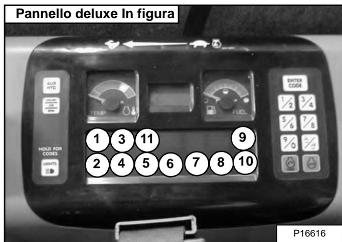
La console destra contiene il pannello degli strumenti con le spie di funzionamento [Figura OI-4].
