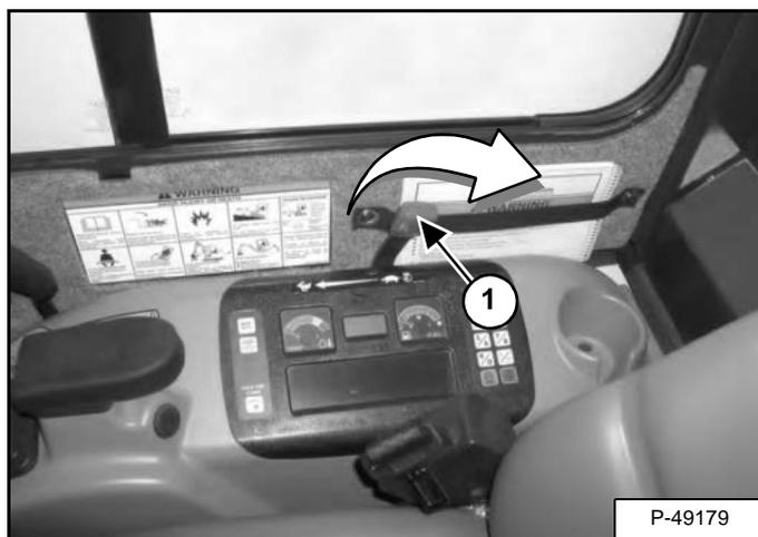
Spingere completamente indietro la leva dell'acceleratore [Figura OI-124].
