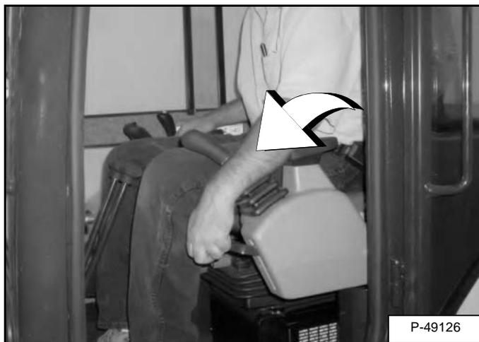
Abbassare la console di comando [Figura OI-49].
